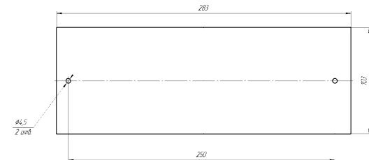
Рисунок 4 – Розмітка отворів на основі корпуса оповіщувачів
