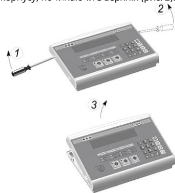
Рисунок 2 - Порядок відкривання корпусу приладу
