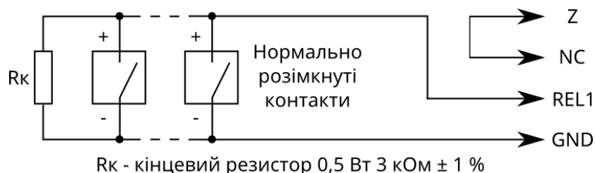
Рисунок 2.7 – Схема підключення двопровідних сповіщувачів з нормально розімкнутими контактами
