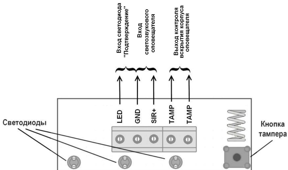
Рисунок 3 - Схема подключения оповещателя
