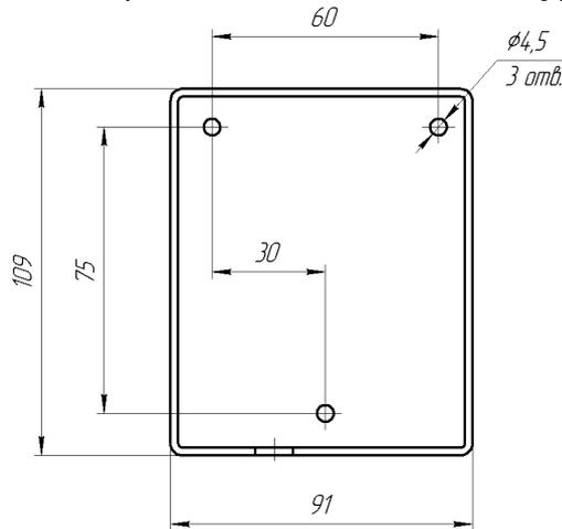
Рисунок 2 – Разметка отверстий в основании корпуса оповещателя
