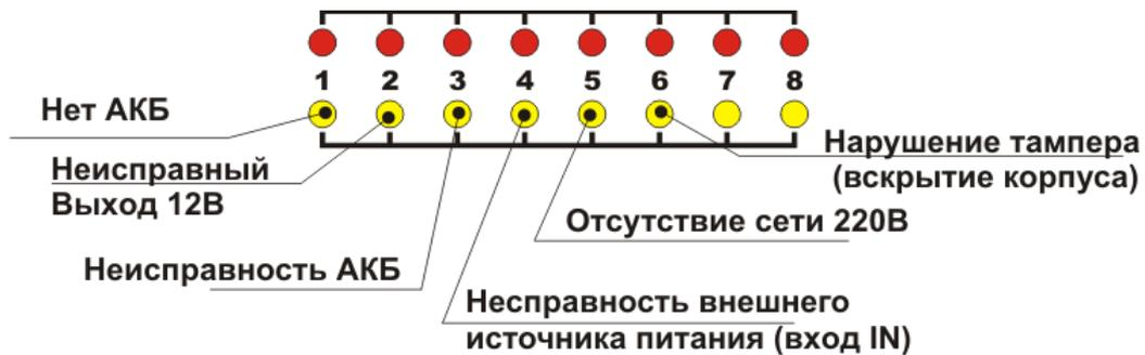
Рисунок 5.4 - Расширенная индикация неисправностей питания для Тирас-8П.1
