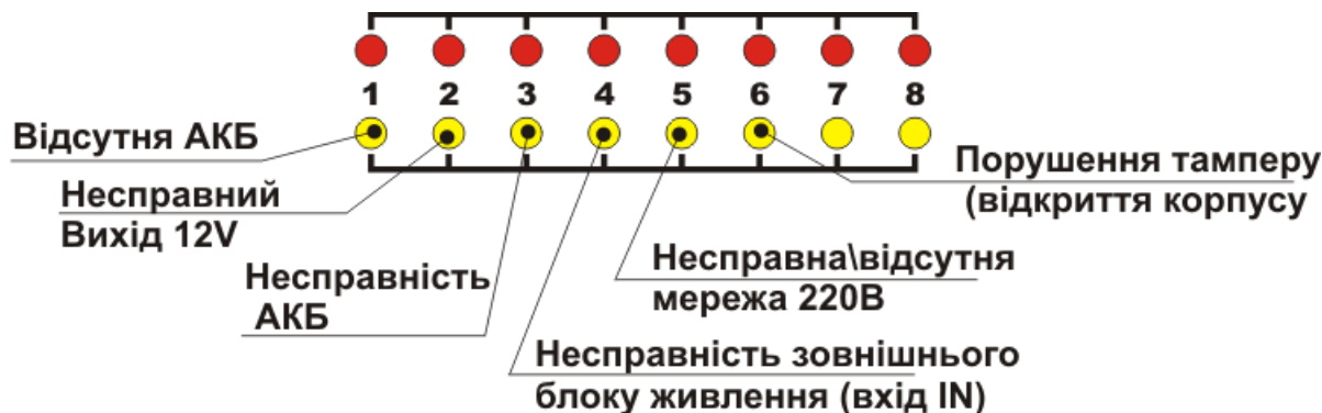
Рисунок 5.2 – Розширена індикація несправностей живлення для Тірас-8П.1
