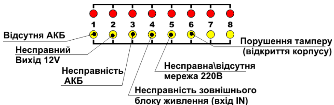
Рисунок 5.3 – Розширена індикація несправностей живлення для Тірас-8П
