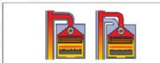
**C42:** Этот тип труб предназначен для котлов, работающих на определенном газовом топливе и используется для вывода воздухозаборной трубы и трубы отвода дымовых газов путем объединения этих 2 труб (коаксиальной трубы или 2 параллельных труб) в одной трубе. Дымоходная труба должна соответствовать требованиям законодательно-нормативных актов.
