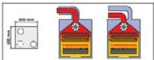
**C12:** Горизонтальная дымоходная труба предназначена для отвода дымовых газов наружу и подачи воздуха для сгорания с использованием коаксиальной дымоходной трубы или 2 параллельных труб (для котлов, работающих на определенном газовом топливе). Между трубами подачи воздуха и отвода дымовых газов необходимо предусмотреть расстояние не менее 250 мм, выходы/оголовки обеих труб необходимо разместить в квадратной части 500 мм.
