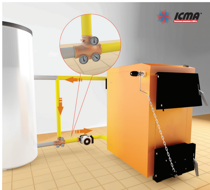
Підключення антиконденсаційного клапана італійської ТМ ICMA арт №133
